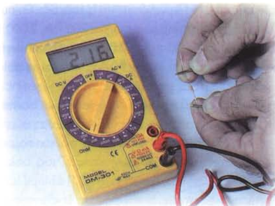
Figura 3.16. Medida de una resistencia de 2.200 \Omega
